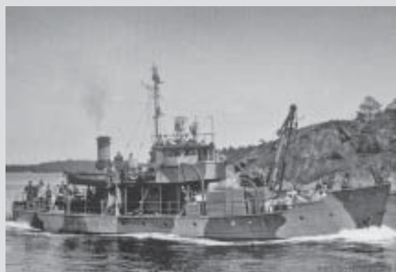
Minutläggare 10, som var utrustad med dieselelektriskt framdrivningsmaskineri.
